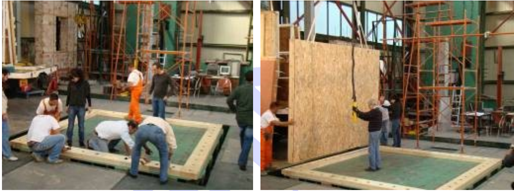
Abb. 4: Holzsockel zur Fixierung des Testkörpers im Erdbebensimulator.
